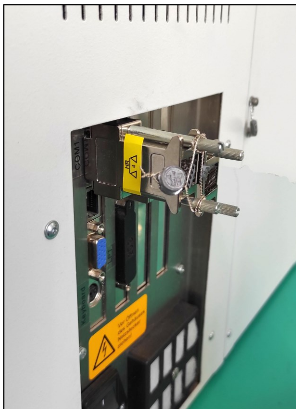
Slika 7 - RS-232 utikač spojen na priključak i osiguran zaštitnim žigom u obliku olovne plombe te zaštitnom oznakom u obliku naljepnice na vijcima odnosno tijelu RS-232 utikača
