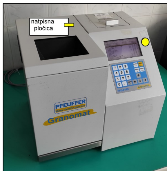
Slika 5. Mjesto za postavljanje natpisne pločice (s gornje stranice kućišta, uz otvor za prihvata ispitnog uzorka) te mjesto za postavljanje ovjerne oznake u obliku naljepnice
